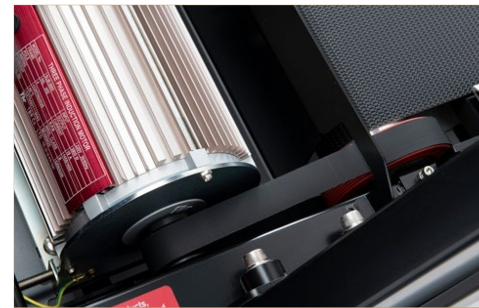
Motore da 6.0 HP AC continuativi, permette un esercizio fino a 25 km/h
